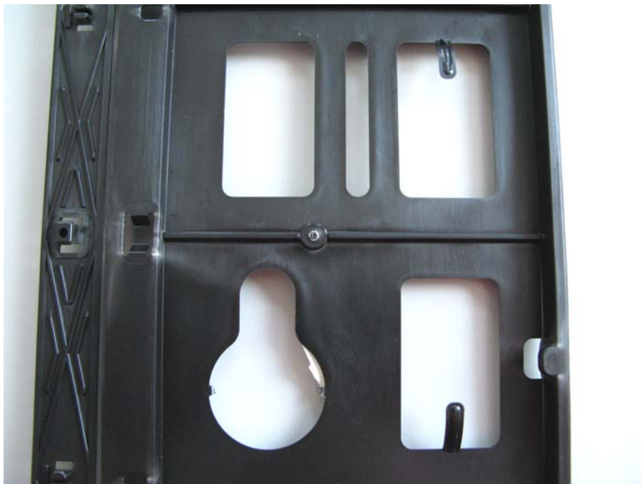
Bild 13: Musterstück "Klimawechsel" nach der Biegeprüfung; Detailaufnahme des beanspruchten Bereichs
