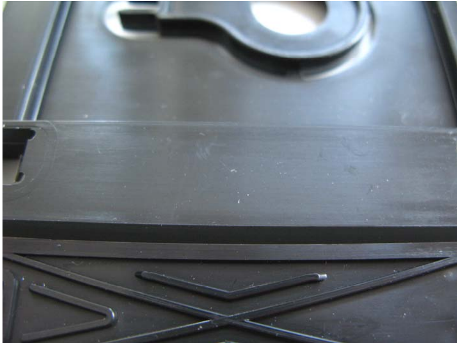
Bild 10: Musterstück nach Prüfung der Stoß-/Schlagfestigkeit bei -20 °C; Detailaufnahme des beanspruchten Bereichs
