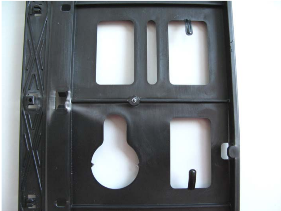
Bild 12: Musterstück "UV-Bewitterung" nach der Biegeprüfung; Detailaufnahme des beanspruchten Bereichs
