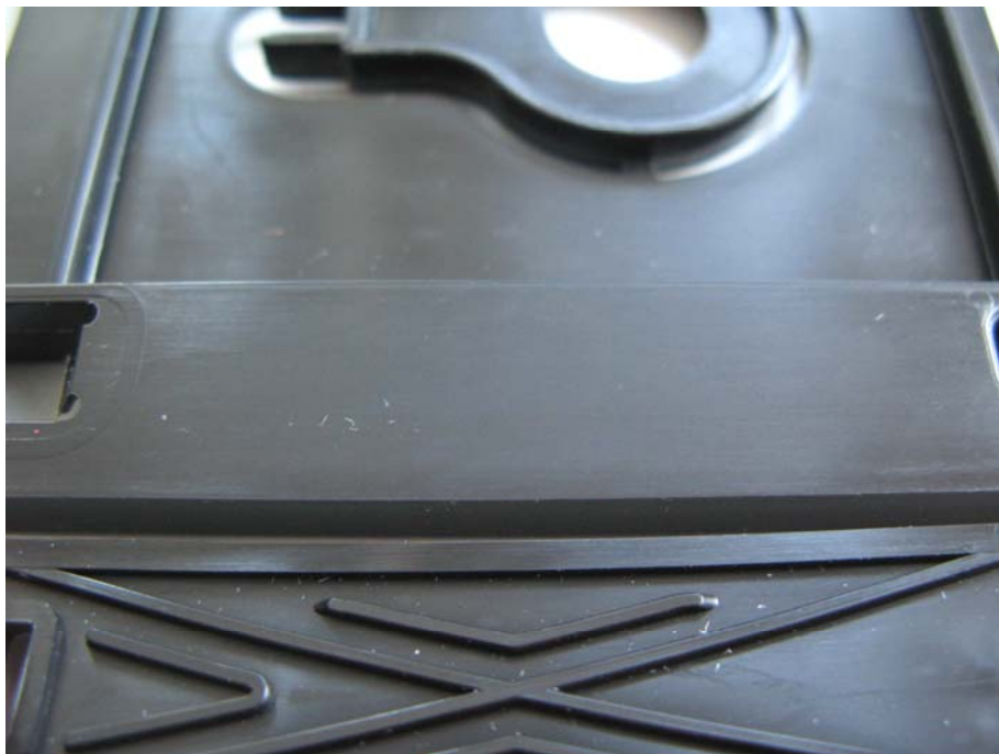
Bild 9: Musterstück nach Prüfung der Stoß-/Schlagfestigkeit bei Raumtemperatur; Detailaufnahme des beanspruchten Bereichs
